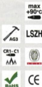
**NF C 32-310** : conducteurs et câbles dits résistants au feu (catégorie CR1), de tension assignée U<sub>0</sub>/U 100 / 170V.
