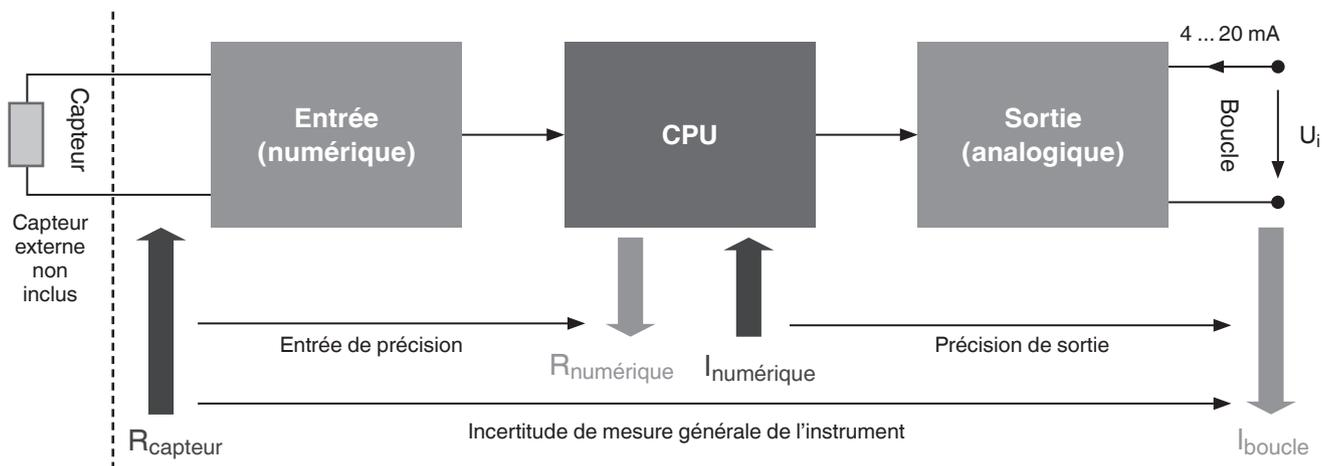
Les spécifications de précision propres au produit se rapportent à l'instrument dans sa totalité ( $\text{Erreur}_{\text{totale}} = \text{Erreur}_{\text{entrée}} + \text{Erreur}_{\text{sortie}}$ ). Pour déterminer l'erreur totale, tous les types possibles d'erreur doivent être pris en considération. Ils sont résumés dans le tableau suivant.
