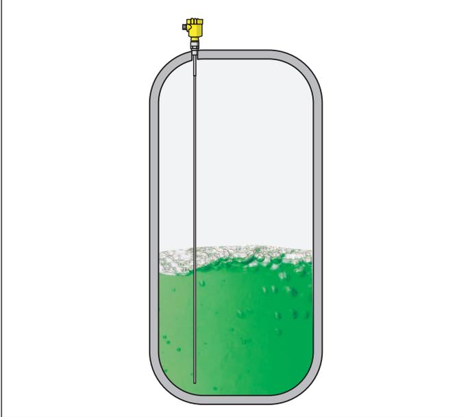
Fig. 28: Mesure de niveau dans une cuve de stockage avec le VEGAFLEX 81
