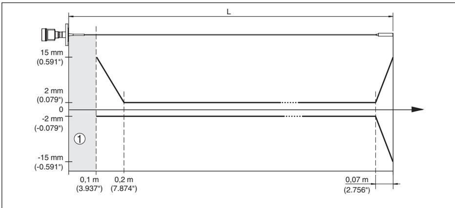
Fig. 44: Écart de mesure VEGAFLEX 81 en version câble ( $\varnothing$  4 mm/0.157 in, revêtu PFA) dans le produit Eau
