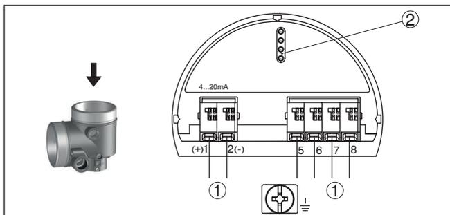
Fig. 14: Compartiment électronique - boîtier à deux chambres
