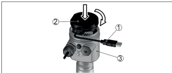
Fig. 30: Raccordement du PC directement au capteur via l'adaptateur d'inter-
