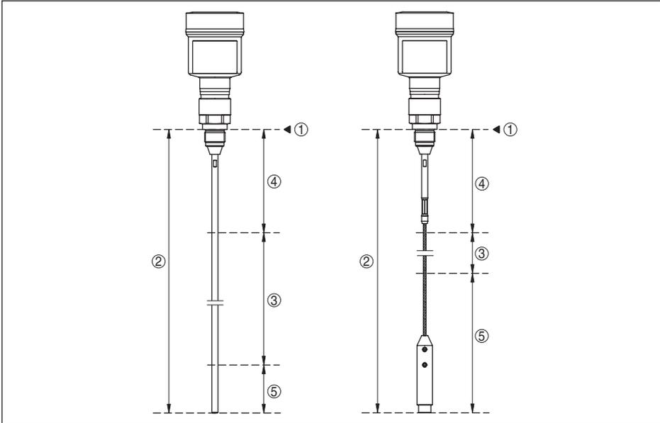
Fig. 38: Plages de mesure - VEGAFLEX 81
