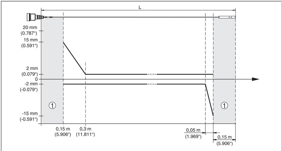
Fig. 43: Écart de mesure VEGAFLEX 81 en version câble ( $\varnothing$  4 mm/0.157 in), dans l'huile
