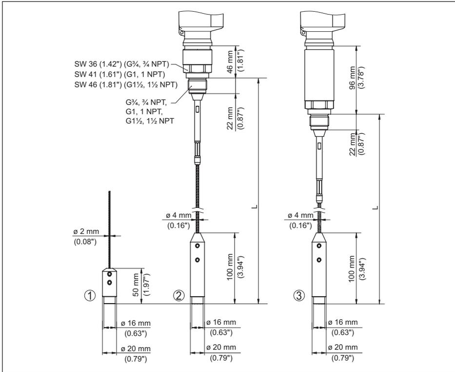
Fig. 53: VEGAFLEX 81, version filetée avec poids tenseur (tous les poids tenseurs avec filetage M8 pour anneau de levage)
