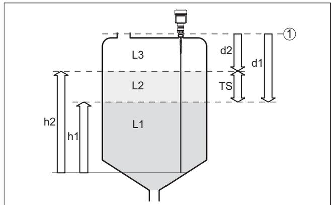
Fig. 2: Mesure d'interface
