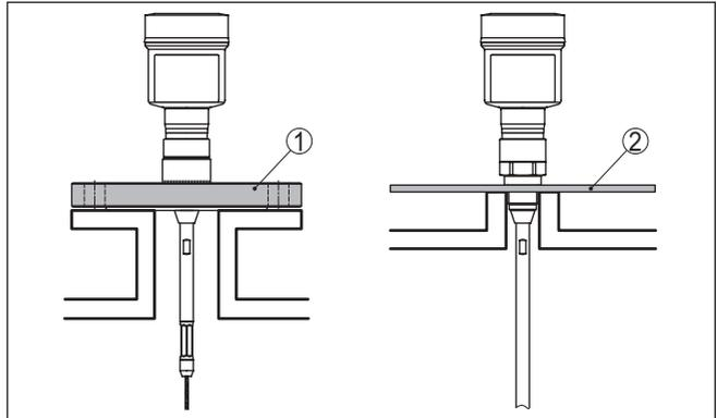
Fig. 4: Montage dans des cuves non métalliques
