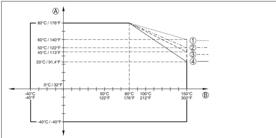
Fig. 46: Température ambiante - température process, version standard
