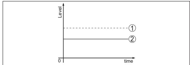
Fig. 35: La ligne en pointillés 1 montre le niveau réel, la ligne continue 2 montre le niveau indiqué par le capteur.
