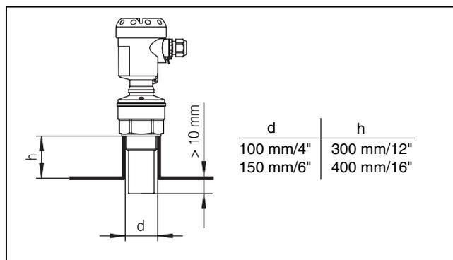
Fig. 8: Autres dimensions de rehausse avec le capteur OPTISOUND 3010 C
