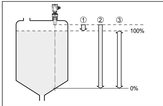
Fig. 4: Plage de mesure et distance de mesure maximale
