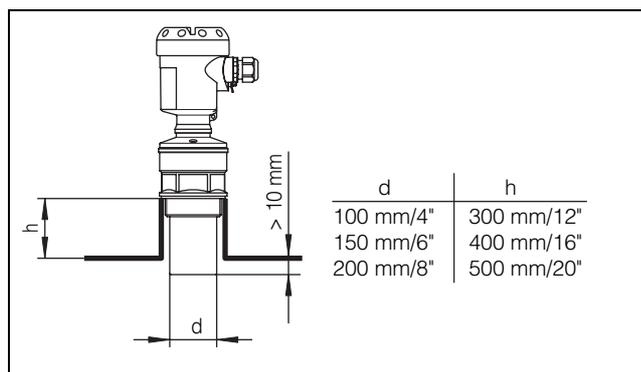
Fig. 9: Autres dimensions de rehausse avec le capteur OPTISOUND 3020 C
