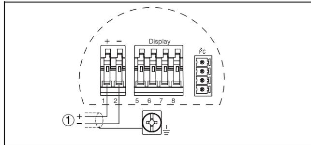
Fig. 16: Raccordement HART - 2 fils
