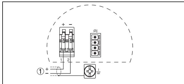
Fig. 17: Raccordement HART - 2 fils
