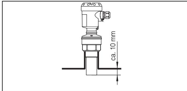
Fig. 7: Montage sur rehausse recommandé
