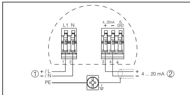
Fig. 18: Raccordement 4 ... 20 mA/HART 4 fils
