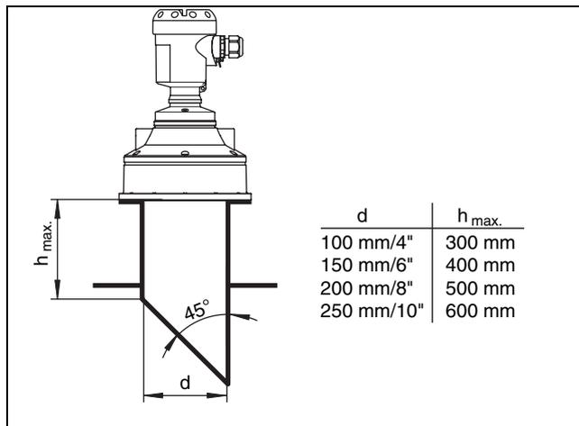
Fig. 10: Autres dimensions de rehausse avec le capteur OPTISOUND 3030 C
