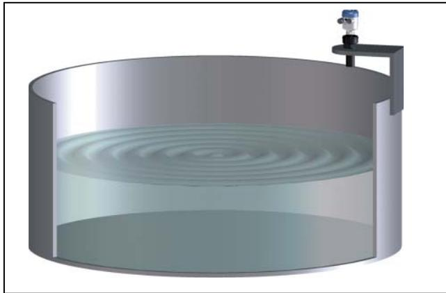
Fig. 1: Mesure de niveau dans un bassin ouvert avec le capteur OPTISOUND 3010 C
