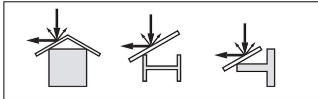
Fig. 13: Recouvrir les obstacles lisses par des déflecteurs
